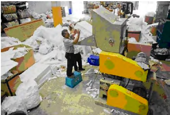
Molienda y extrusión del EPS.
