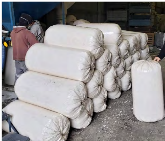
EPS molido para uso en construcción y rellenos (Cooperativa Reciclando Sueños).
